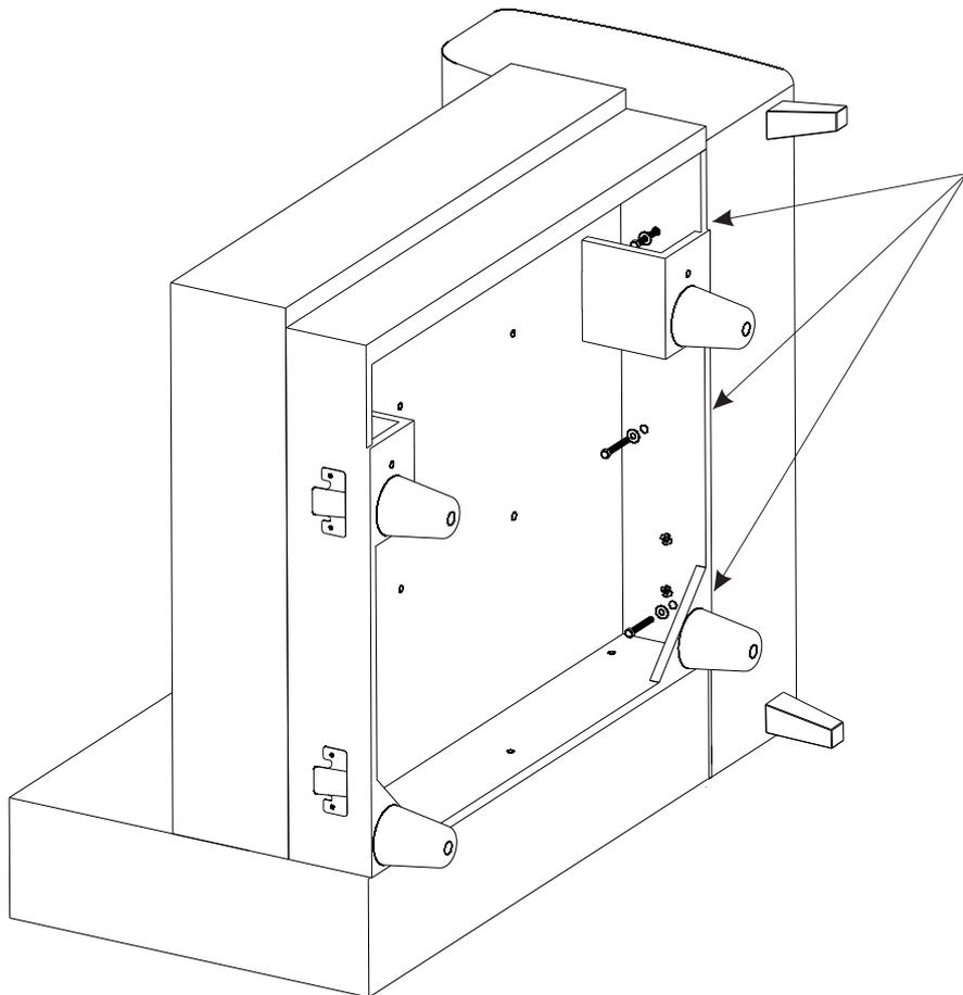
Надеть на болт между подлокотником и модулем кольцо утяжки **U**
